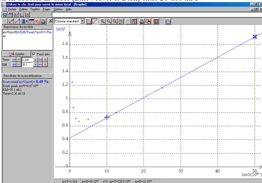
On détermine :  $KM = 70.1 \text{ mM}$        $V_{\max} = 2.36 \text{ uA/2 min}$
