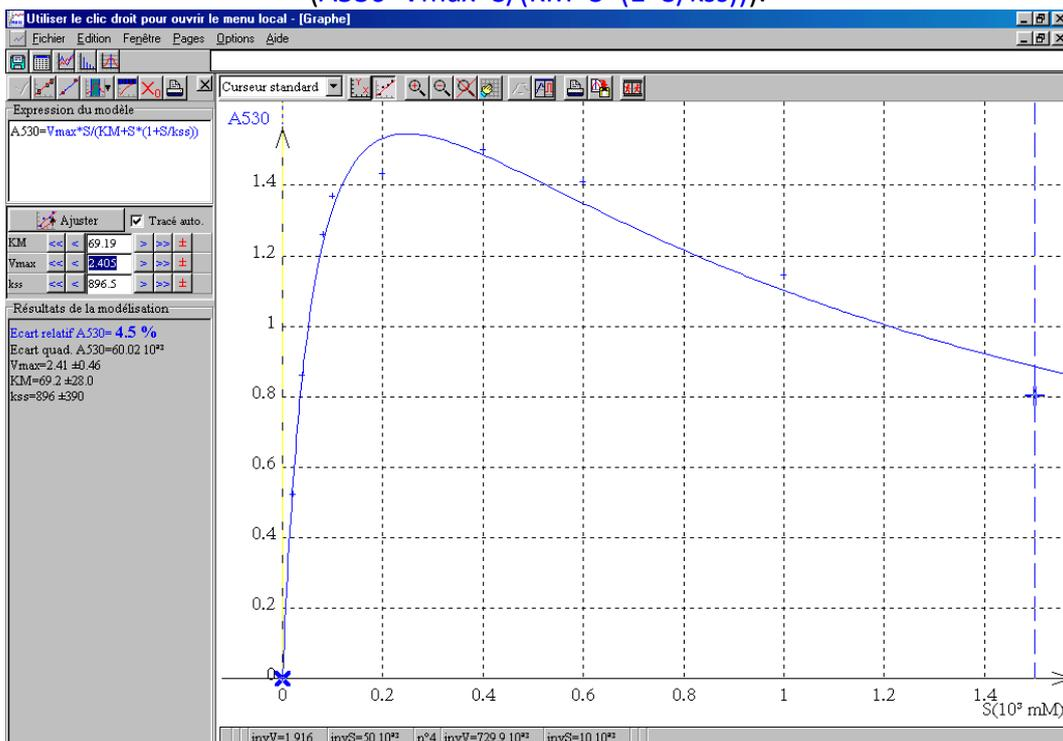
Les valeurs calculées sont :  $KM = 69.2 \text{ mM}$        $V_{\max} = 2.41 \text{ uA/2 min}$        $K_{ss} = 900 \text{ mM}$
